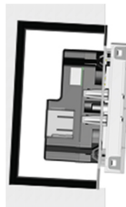
Unterputzdose falsch eingebaut
