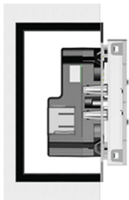
Unterputzdose richtig eingebaut
