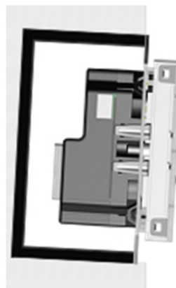
Unterputzdose falsch eingebaut
