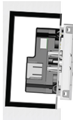
Unterputzdose falsch eingebaut
