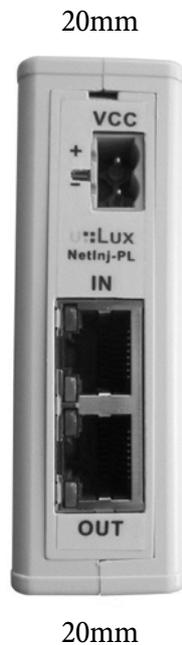
Die Gehäusehöhe beträgt ca. 80mm. Bitte beachten Sie, dass für die nach oben weggehenden Ethernet-Anschlüsse zur Gehäusetiefe noch ca. 50mm dazukommen. In Summe ist daher eine freie Einbautiefe von ca. 130mm notwendig. Bitte berücksichtigen Sie dies bei der Auswahl eines geeigneten Verteilerkastens (Wandschranks).
