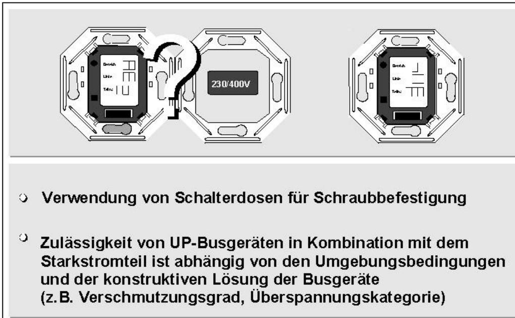
Figure 13: Einbau UP Busgeräte
