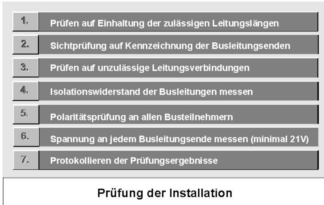
Figure 19: Prüfung der Installation
